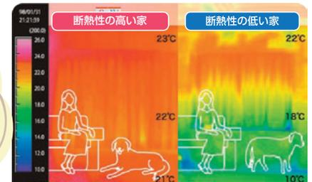
壁面温度熱画像による部屋の上下温度差の比較:実在住宅測定例 (赤系ほど温度が高く、青系ほど温度が低いことを示します。)
